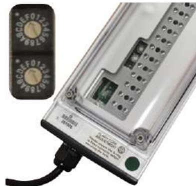
Flitscode instelling via draaibare schakelaars
